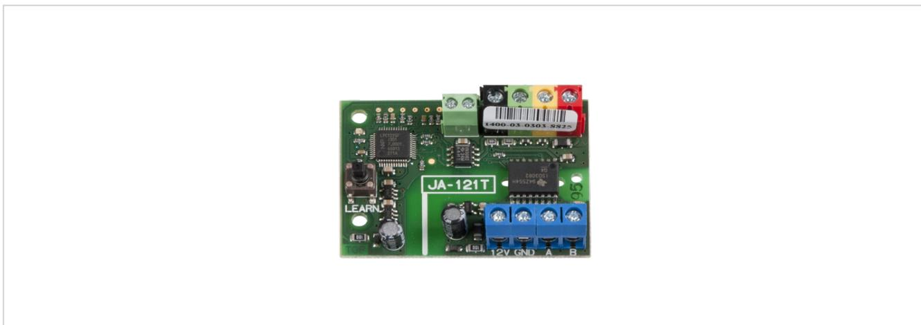
Die RS-485 BUS-Schnittstelle dient zur Übertragung von Meldungen, Zuständen und Texten aus dem JABLOTRON 100 Alarmsystem an externe Systeme z.B. KNX Systeme.
