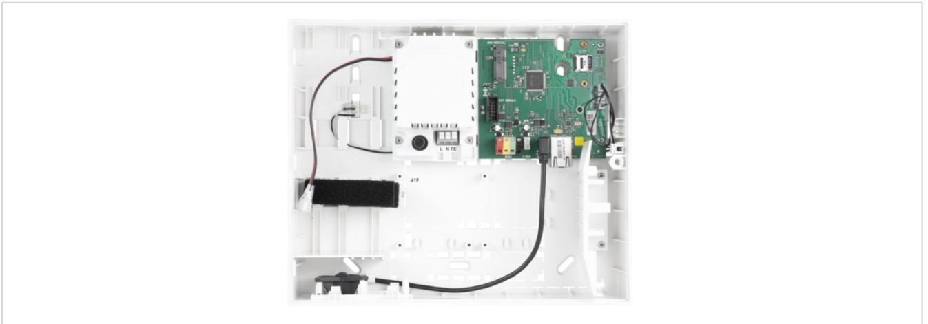
Die Kompaktalarmzentrale JA-103K mit integriertem K- LAN-Übertragungsgerät ist das Kernelement von JABLOTRON 100+ zum Schutz von Gebäuden.
