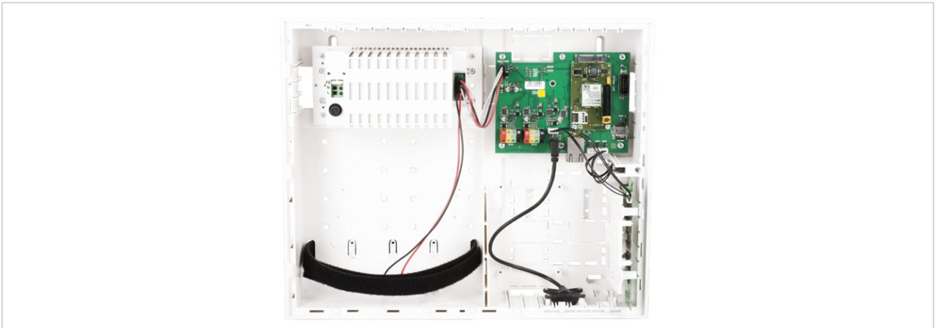
Die neue JA-107KR mit LAN-Übertragungsgerät und ein Funkmodul (JA-111R) ist bereits integriert. Diese Jablotron Zentrale ist für größere Objekte geeignet.
