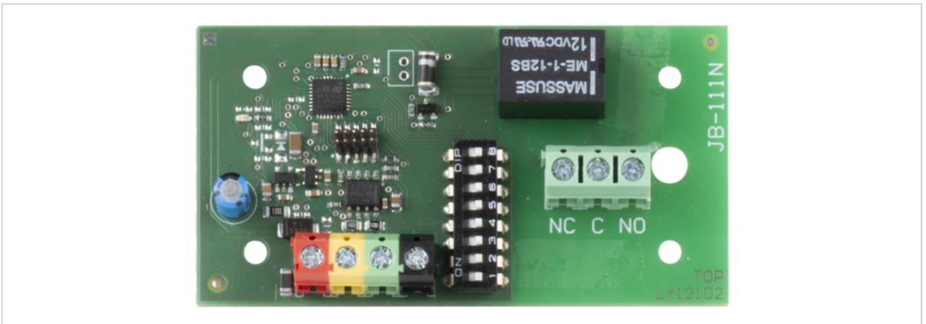
Das BUS-12 V Relaismodul verfügt über einen schaltbaren Steuerausgang (PG-Ausgang). Mit diesem Steuerausgang können verschiedene Funktionen und Steuerbefehle von dem JABLOTRON 100/100+ Alarmsystem umgesetzt werden z.B. Ansteuerung von Rolltoren, Garagentoröffner etc.
