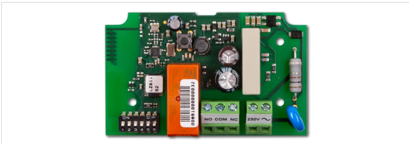
Das FUNK- 230 V Relaismodul verfügt über einen schaltbaren Steuerausgang (PG-Ausgang). Externe 230 V Geräte können von dem JABLOTRON 100 Alarmsystem direkt angesteuert und geschaltet werden.
