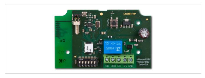
Das FUNK-12 V Relaismodul mit schaltbarem Steuerausgang (PG-Ausgang) und verschiedene Funktionen und Steuerbefehlen können von dem JABLOTRON 100 Alarmsystem umgesetzt werden.
