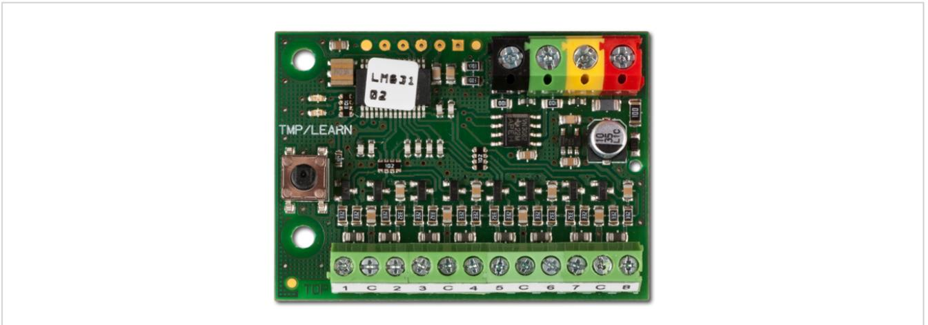
Das BUS-Eingangsmodul mit 8 Eingängen ermöglicht den Anschluss von bis zu 8 verkabelten Komponenten an das JABLOTRON 100+ Alarmsystem.
