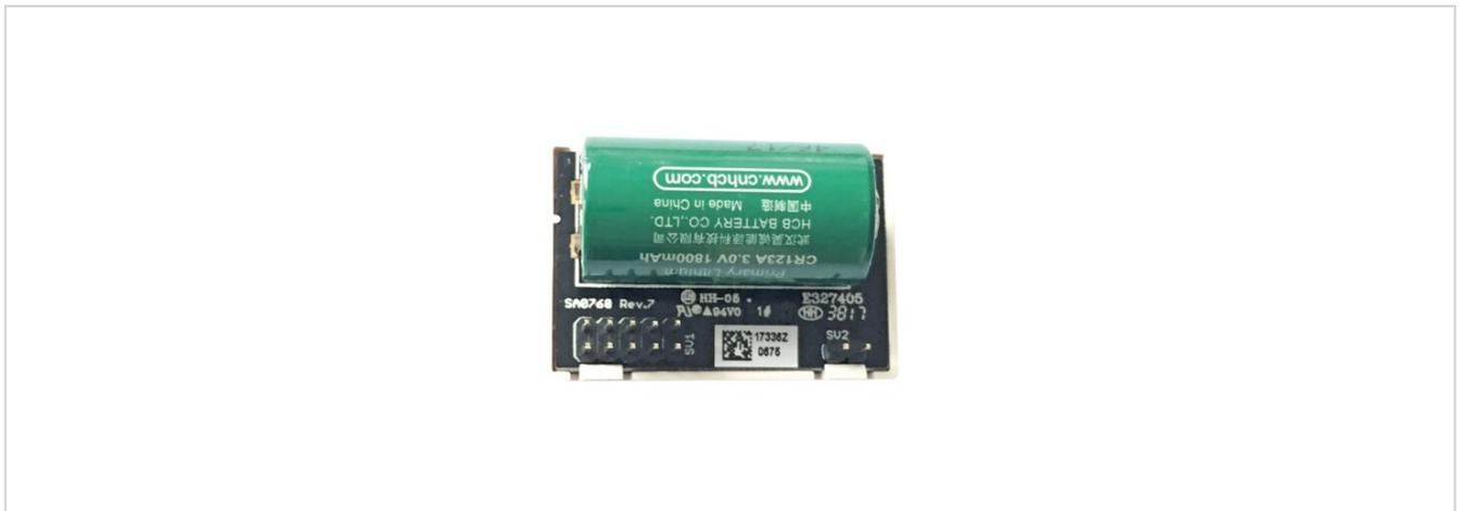
Das FireAngel W2-Funkmodul P-Line ermöglicht die Vernetzung aller FireAngel Produkte, die mit einer Funkschnittstelle ausgestattet sind. Bei einem Alarm werden alle vernetzten Funkteilnehmer gleichzeitig alarmiert.
