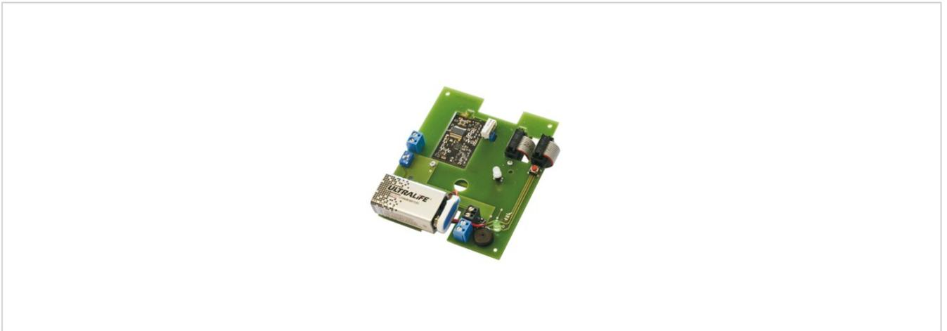
Das W2-Relaismodul mit integriertem W2-Funkmodul bietet die Möglichkeit externe Geräte anzusteuern und Alarmmeldungen aus dem W2-Netzwerk weiterzuleiten. Es kann sowohl als Eingangsmodul oder als Ausgangsmodul verwendet werden.
