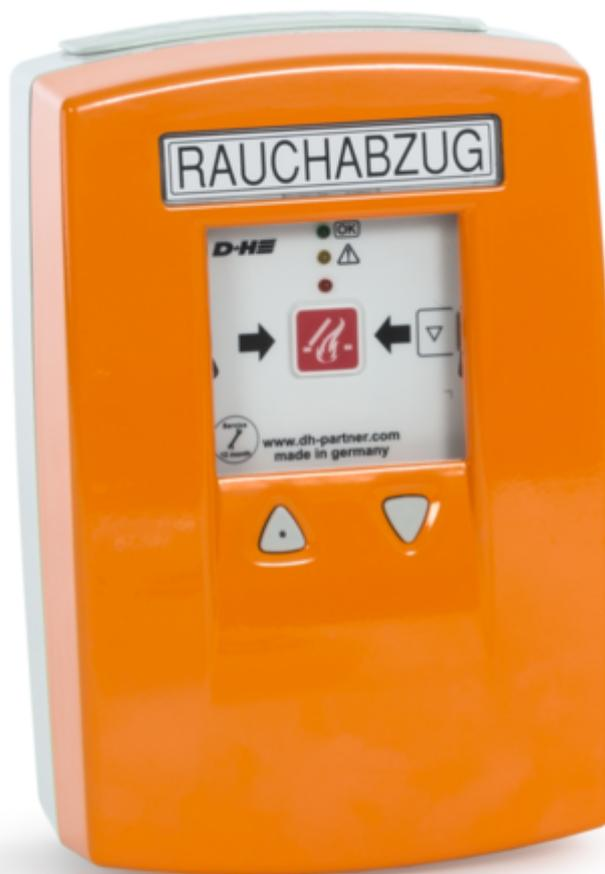
Vereinigt RWA Zentrale, Lüftungstaster & Auslösetaster in einem Gehäuse. Die D+H Zentrale ist mit 3 A Leistung ideal für Treppenhäuser & einzelne Räume. VdS zertifiziert nach ISO 21927-9, erfüllt die DIN 18232-9.
