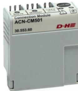
Das Connection-Modul ist ein Zugang für alle AdComNet-ready Steuerungen im Buskommunikationsnetz. Es entsteht hiermit ein leistungsstarkes Netzwerk.
